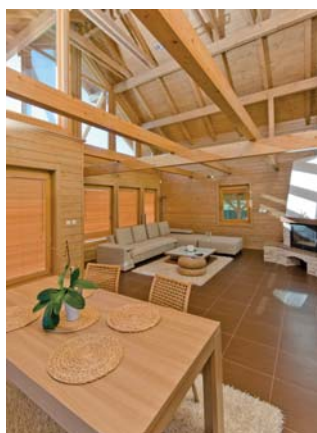
Srubový dům s prosklenými štíty, konstrukce z lepených hranolů, užitná plocha 168 m 2
